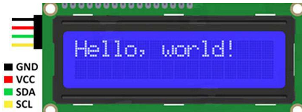
Рис. 1. Подключение модуля ЖКИ к Ардуино
