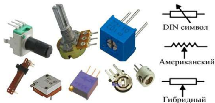
Рис. 10. Переменные резисторы (потенциометры)
